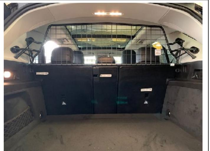
Trenngitter im montierten Zustand.
