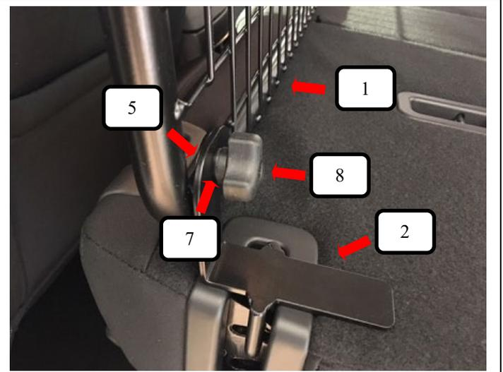
Trenngitter (Pos. 1) in das Fahrzeug einbringen und vor die Bodenhalterung links + rechts (Pos. 2) stellen. Den Bodenhalter links + rechts (Pos. 2) mittels einer Schlossschraube (Pos. 5), Unterlegscheibe (Pos. 7) und Rändelmutter flach (Pos. 8) mit dem Trenngitter (Pos. 1) verbinden und festziehen.
