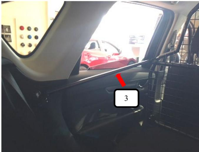
Streben links + rechts (Pos. 3) im montierten Zustand.
