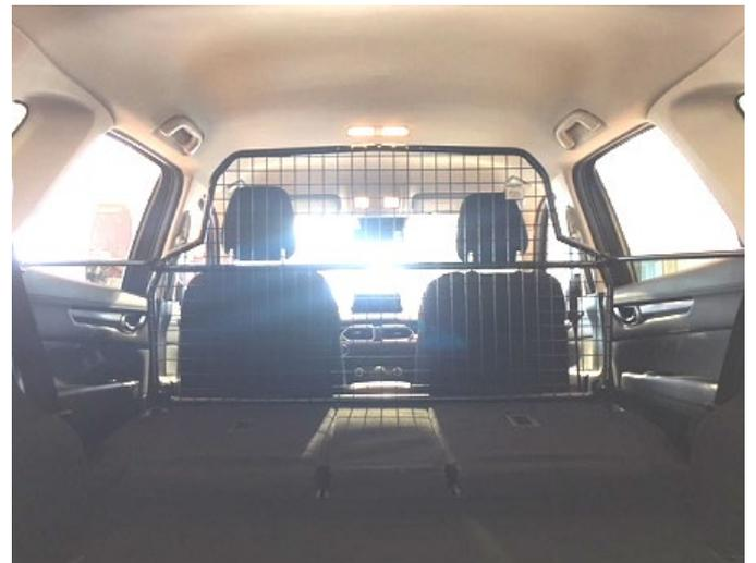
Trenngitter (Pos. 1) im montierten Zustand.
