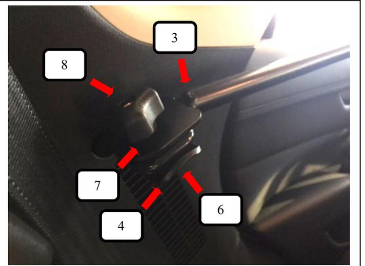
Streben links + rechts (Pos. 3) von oben auf die Rücksitzbank-Arretierung und von unten die Gegenplatte (Pos. 4) halten und eine Schlossschraube (Pos.6) durchstecken. Jetzt eine Unterlegscheibe (Pos. 7) und Rändelmutter flach (Pos.8) aufschrauben und festziehen.
