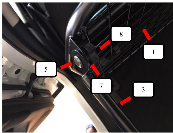
Streben links + rechts (Pos. 3) von außen an das Trenngitter (Pos. 1) halten, von außen eine Schlossschraube (Pos. 5) durchstecken und dann eine Unterlegscheibe (Pos. 7) und Rändelmutter flach (Pos.8) aufschrauben und festziehen.
