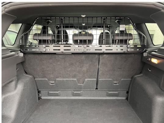
Masterline Universaltrenngitter im montierten Zustand.
