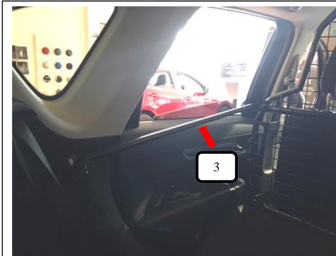
Streben links + rechts (Pos. 3) im montierten Zustand.
